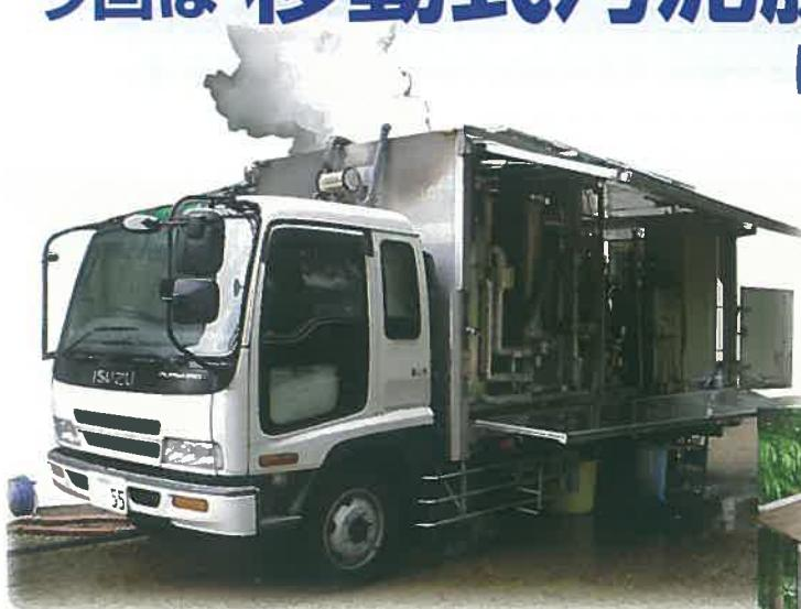
移動式汚泥脱水乾燥車は、下水処理場から発生する汚泥の脱水及び乾燥処理を行なうことを目的としています。
